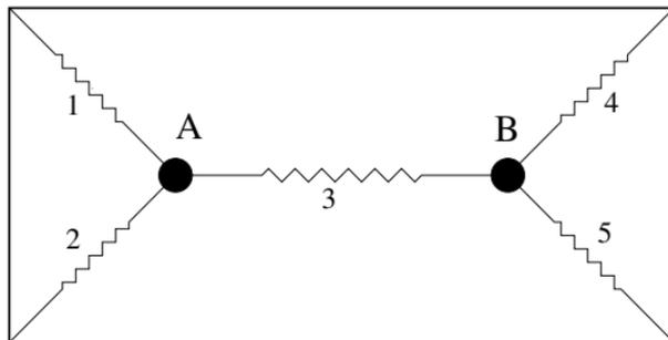
1. Escreva, para pequenos deslocamentos de A e B das posições relaxadas, a energia elástica do sistema como uma forma quadrática nas variáveis  $x_1^A, x_2^A, x_1^B, x_2^B$ . Identifique a matriz  $A$  tal que, sendo  $u$  o vetor de deslocamentos, se cumpra
