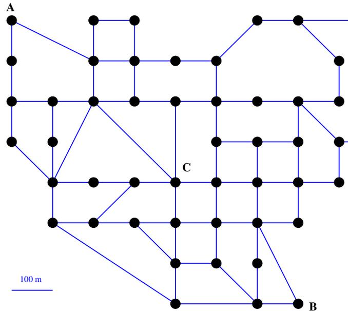
**Problema 4:** Cada canal é capaz de levar uma vazão máxima  $Q_{\max}$ , acima da qual transborda e gera alagamentos. Os valores de  $Q_{\max}$  são conhecidos para cada canal, de fato todos os conectados com os nós A, B ou C tem  $Q_{\max} = 200m^3/h$ , e todos os outros tem  $Q_{\max} = 50m^3/h$ .
