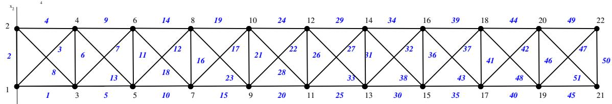
Consideremos a treliça da figura, cujas conectividade e coordenadas estão nos arquivos “coneck.txt” e “coord.txt” no site, formada por barras articuladas de  $E = 1 \times 10^{11}$  Pa e seção transversal de  $10^{-5}$  m<sup>2</sup>. Sendo 51 barras e 22 nós, fazemos
